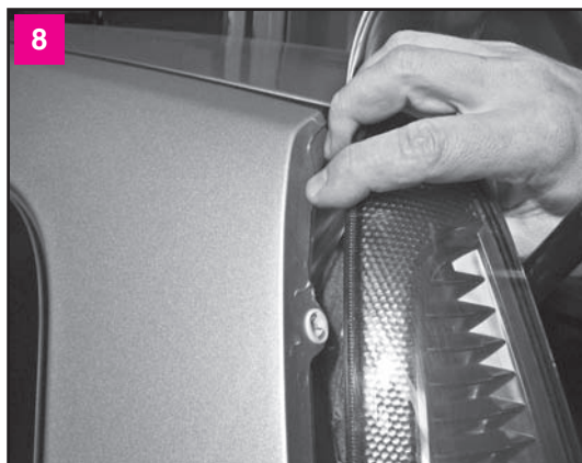
8 Удерживая одной рукой верхнюю часть фонаря, другой полностью отворачиваем гайку-барашек со стороны багажника
