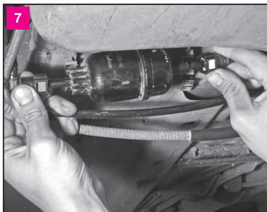
Нажимаем на фиксаторы наконечников топливопроводной трубки и снимаем их со штуцеров топливного фильтра. При снятии фильтра из него и из топливных трубок может вытечь некоторое количество топлива — подставьте емкость
