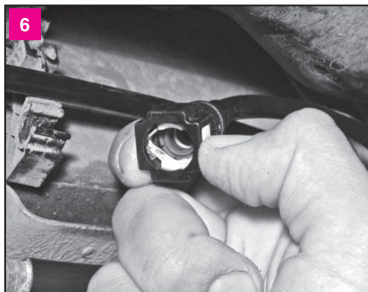
Для снятия наконечника топливной трубки нужно одновременно нажать на два фиксатора (показано на отсоединенном наконечнике)
