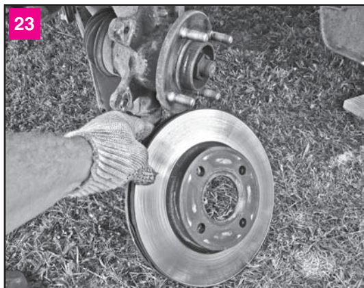
Снимаем тормозной диск со шпилек ступицы колеса. Перед установкой диска очищаем его посадочное место и фланец ступицы. Устанавливаем новые колодки и тормозной диск в обратной последовательности
