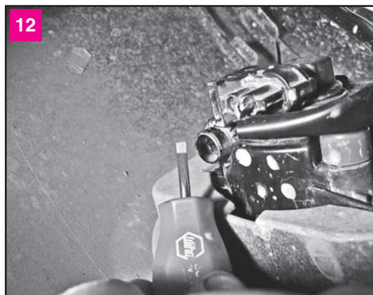
Для корректировки направления светового пучка противотуманной фары в вертикальной плоскости вращаем регулировочный винт по часовой стрелке, поднимая пучок, либо против часовой стрелки, опуская пучок
