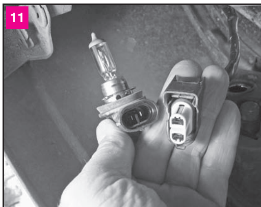
Нажимаем на фиксатор колодки проводов и отсоединяем колодку от разъема лампы. Снимаем лампу. Новую лампу устанавливаем в обратной последовательности
