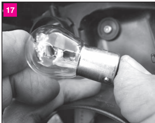
17 Внешний вид лампы указателя поворота. Новую лампу устанавливаем в обратной последовательности
