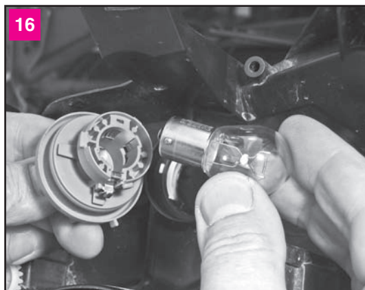
16 Слегка нажимая на колбу лампы, утапливаем ее в патрон, поворачиваем против часовой стрелки и вынимаем из патрона
