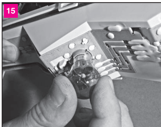
Слегка нажимая на лампу, утапливаем ее в держатель, поворачиваем против часовой стрелки и вынимаем. Аналогично вынимаем другие лампы
