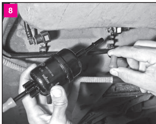
Перед установкой нового фильтра снимаем с его штуцеров защитные заглушки. Устанавливаем фильтр так, чтобы стрелка на его корпусе (см. фото 5) указывала на правый борт автомобиля
