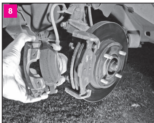
Снимаем суппорт и вынимаем внутреннюю тормозную колодку из направляющей
