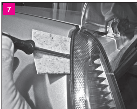
7 В зазор между верхней частью фонаря и кузовом вставляем кусок смягчающего материала (картона, линолеума). Лезвием шлицевой отвертки сдвигаем фонарь на себя, выводя его верхний фиксатор из пластмассовой втулки
