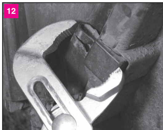
Снятые детали устанавливаем в обратной последовательности. При установке брызговика прижимаем его к отбортовке крыла и раздвижными пассатижами сжимаем три защелки
