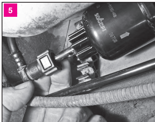
Выводим поочередно штуцеры топливного фильтра из кронштейнов
