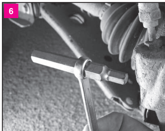
Шестигранником «на 7» отворачиваем поочередно против часовой стрелки два направляющих пальца суппорта. Удобнее работать накидным ключом, надетым на шестигранную насадку (биту)
