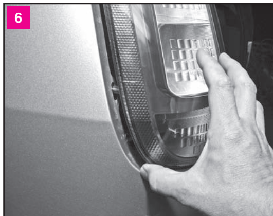
6 Отдвигаем нижнюю часть фонаря, насколько позволит оставленная на резьбе гайка-барашек, и оставляем фонарь в таком положении
