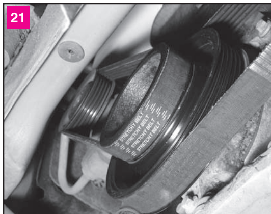
Правильное расположение приводных ремней — между отбортовками шкивов
