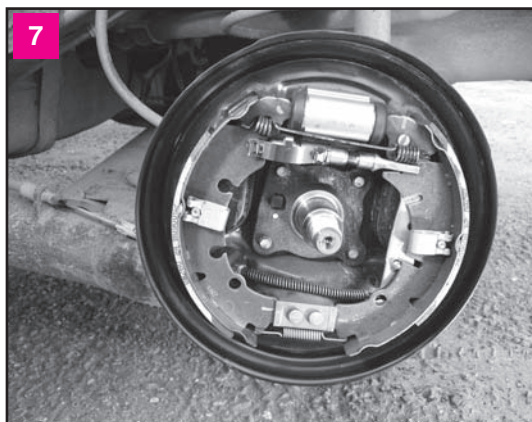
Расположение деталей заднего левого тормозного механизма
