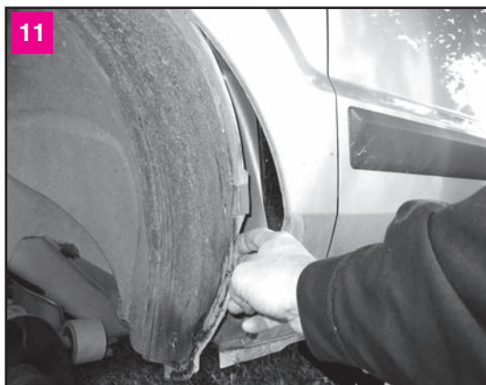
Выводим край подкрылка из-за отбортовки крыла, отгибая его рукой. За подкрылком на ощупь нажимаем на фиксатор указателя и толкаем его наружу. Дальнейшие операции по замене лампы аналогичны описанным выше
