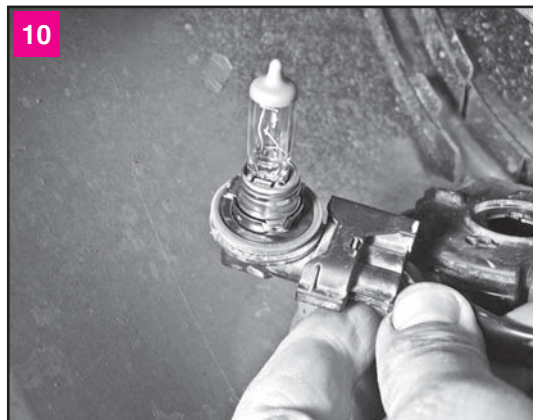
Для замены лампы поворачиваем ее за корпус против часовой стрелки до упора и вынимаем из корпуса фары
