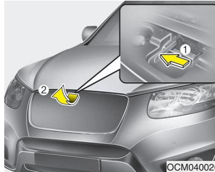
2. Подойти к транспортному средству спереди, немного приподнять капот, нажать на дополнительную защелку (1), расположенную под капотом в средней части, и поднять капот (2).
