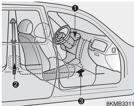
Система преднатяжителей ремней безопасности состоит из следующих основных элементов. Их расположение показано на иллюстрации:
