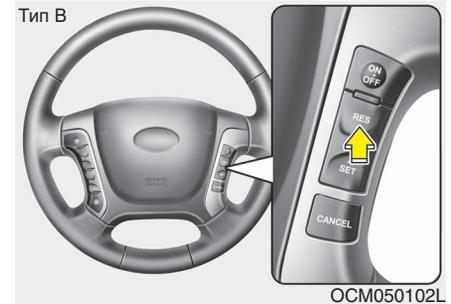
3. Нажмите выключатель -SET (Накат/установка) и отпустите его на нужной скорости. На приборной панели загорится контрольная лампа SET (Установка). Одновременно с этим отпустите педаль газа. Желаемая скорость будет поддерживаться автоматически.
