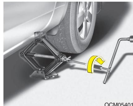
7. Установите домкрат в переднее или заднее положение для домкрата, ближайшее к заменяемому колесу. Ставьте домкрат в специально предназначенных местах под рамой. Места для установки домкрата представляют собой приваренные к раме пластины с двумя выступами и приподнятым краем для контакта с домкратом.
