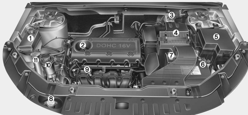
1. Расширительный бачок для жидкости системы охлаждения
