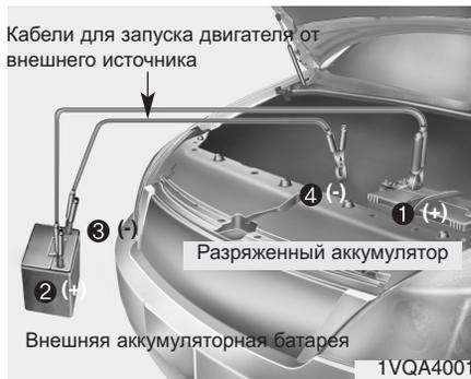
Подключайте кабели в прямой последовательности нумерации, а отсоединяйте - в обратной.
