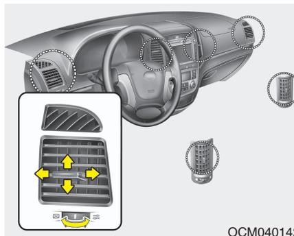
**Вентиляционные отверстия в панели приборов**
