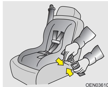
2. Вставьте язычок замка трехточечного ремня безопасности в пряжку. При соединении должен быть ясно слышан щелчок.
