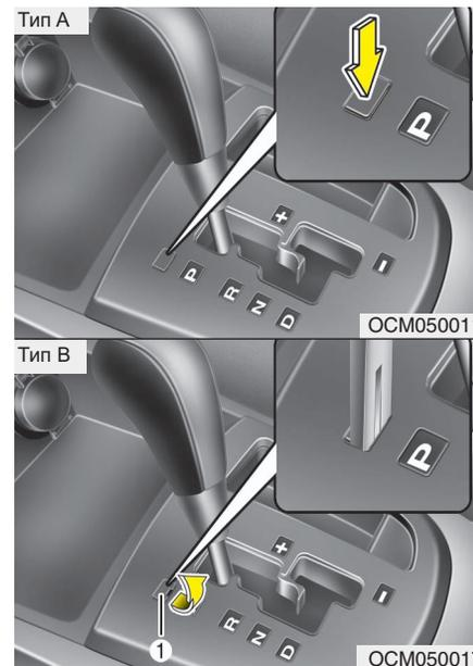
**Снятие блокировки переключения передач**
