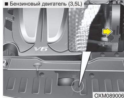
Серийный номер двигателя выбит на блоке цилиндров, как показано на рисунке.
