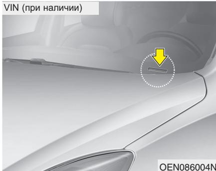
Идентификационный номер автомобиля (VIN) также имеется на табличке в верхней части приборной панели. Номер на этой табличке хорошо виден снаружи автомобиля через ветровое стекло.
