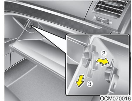
2. При открытом перчаточном ящике: удалить с обеих сторон стопоры.
