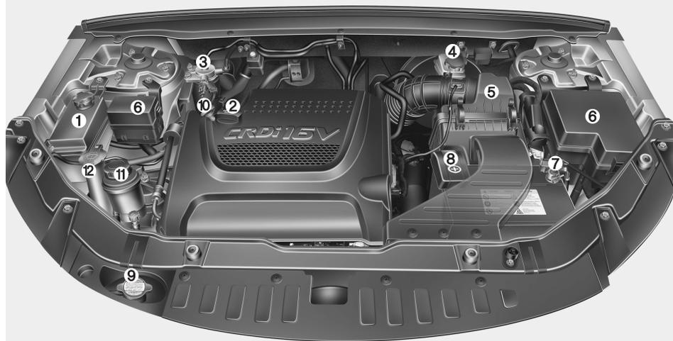
1. Расширительный бачок для жидкости системы охлаждения
