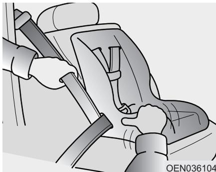
Если необходимо натянуть ремень, подайте ленту ремня внутрь кожуха устройства автоматического натяжения. Если расстегнуть ремень безопасности и дать ему возможность втянуться внутрь кожуха устройства автоматического натяжения, это устройство автоматически вернется в свое нормальное рабочее положение.
