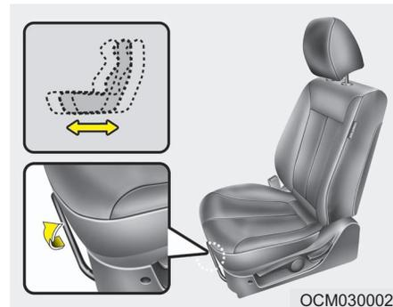
**Регулировка переднего сиденья - механическая (при наличии)**
