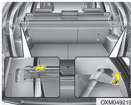
Для использования защитного багажного экрана потяните рукоятку назад и вставьте края в гнезда.
