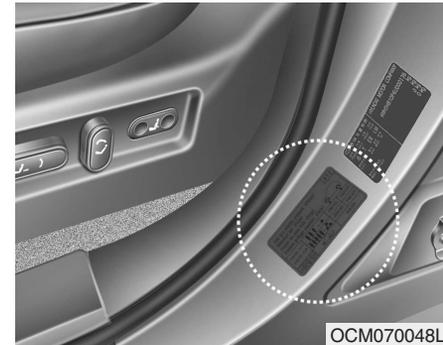
Все технические характеристики (размеры и давление) приведены в табличке, прикрепленной к автомобилю.
