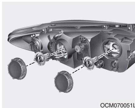
4. Снимите крышку лампы фары, повернув ее против часовой стрелки.
