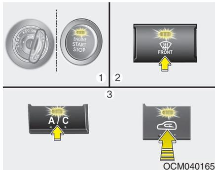
Дисплей системы кондиционирования мигнет 3 раза с перерывом 0,5 секунды. Это указывает на отмену алгоритма работы системы устранения запотевания или ее возврат в ранее запрограммированное состояние.
