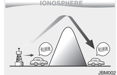
Сигналы AM (MW, LW)-диапазона могут приниматься на большем удалении от радиостанции, чем сигналы FM-диапазона. Это возможно за счет более низкой частоты радиоволн AM (MW, LW)-диапазона. Эти радиосигналы с большой длиной волны и низкой частотой распространяются не по прямой линии в атмосфере, а могут огибать земную поверхность. Кроме того, они огибают препятствующие их распространению объекты, что обеспечивает лучший прием сигнала.
