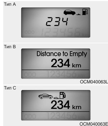
**Расстояние, которое автомобиль может проехать с имеющимся запасом топлива в баке (при наличии) (км или миль)**
