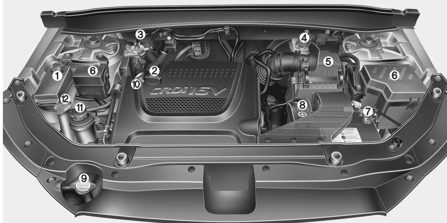
1. Расширительный бачок для жидкости системы охлаждения .....7-31
