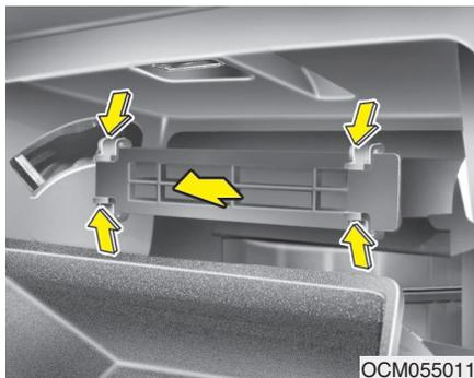
3. Снимите корпус воздушного фильтра системы управления микроклиматом, потянув за крышку с двух сторон.
