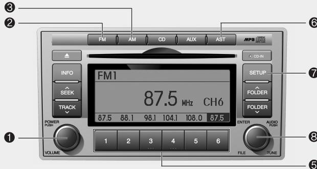
1. Кнопка ВКЛ./ВЫКЛ. питания и ручка регулировки громкости
