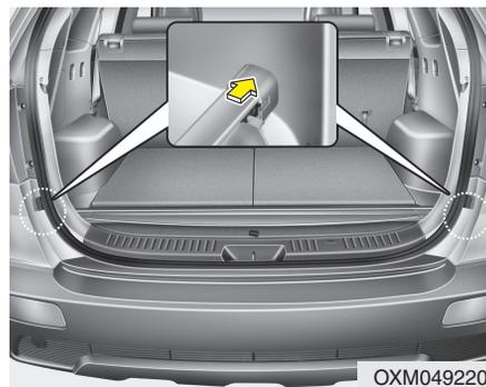
Если защитный экран багажного отделения не используется, разместите его в нижней части багажного отделения (при наличии).
