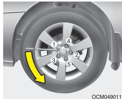
6. Ослабьте каждую колесную гайку одним оборотом против часовой стрелки, но не откручивайте их до конца до отрыва колеса от земли.
