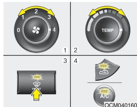
**Система управления микроклиматом с ручным управлением****Для устранения запотевания внутренней стороны ветрового стекла**
