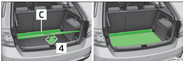
Илл. 72 Перевод трансформируемого пола в нижнее положение / трансформируемый пол в нижнем положении
