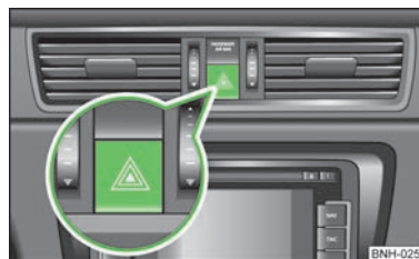
Илл. 24 Кнопка аварийной световой сигнализации.
