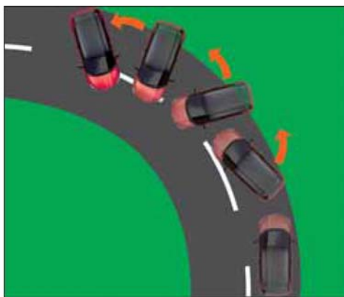
У автомобилей с функцией СВС в случае избыточной поворачиваемости давление в контурах колёс, движущихся по внутреннему радиусу поворота, снижается.
